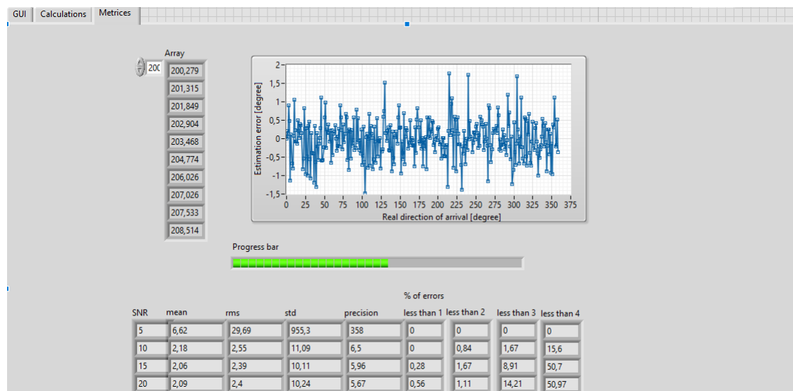
Rys.5.1c: Trzecie okno aplikacji przedstawiające wyniki przeprowadzonych symulacji
