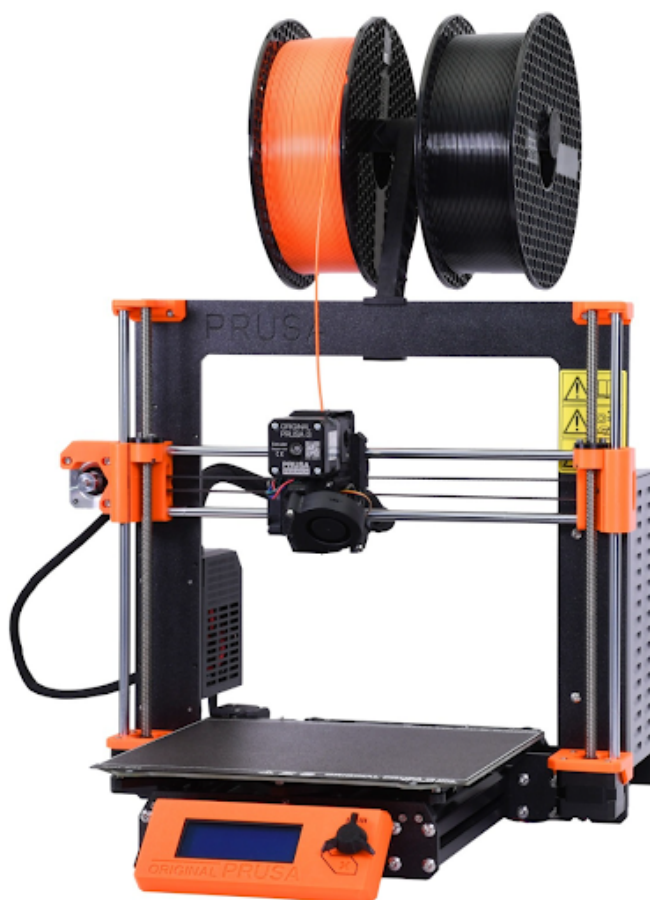
Rysunek 5.1. Prusa i3Mk3s - najbardziej popularna drukarka 3D technologii FDM[32]
