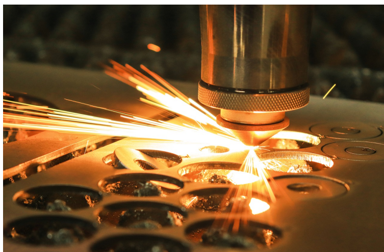
Rysunek 5.7. Przemysłowy laser podczas pracy
