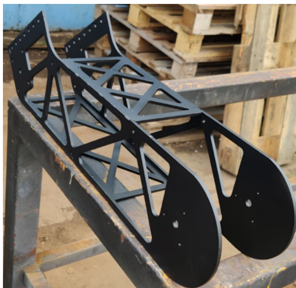
Rysunek 5.9. Kratownica po wyspawaniu i pomalowaniu
