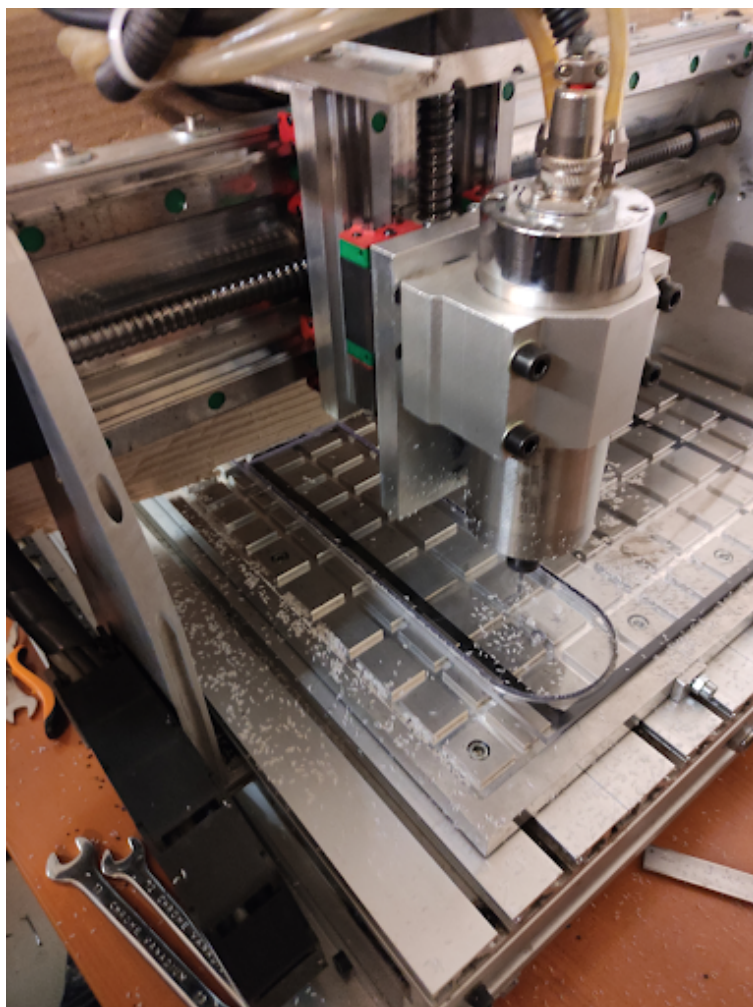
Rysunek 5.4. Frezarka podczas obróbki szkła akrylowego
