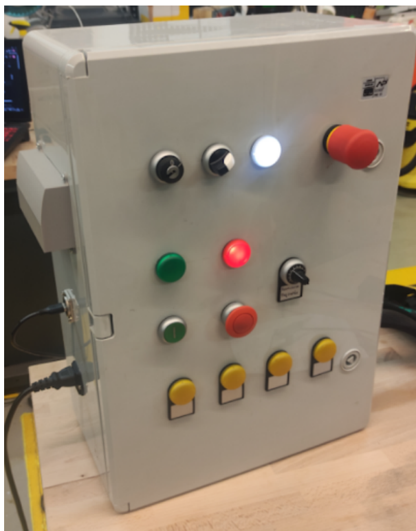
Rysunek 5.21. Szafa sterownicza podczas pracy
