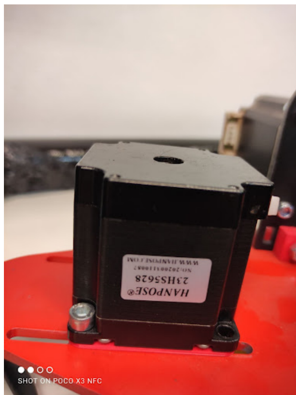
Rysunek 3.4. Silnik krokowy napędzający pas zębaty podstawy
