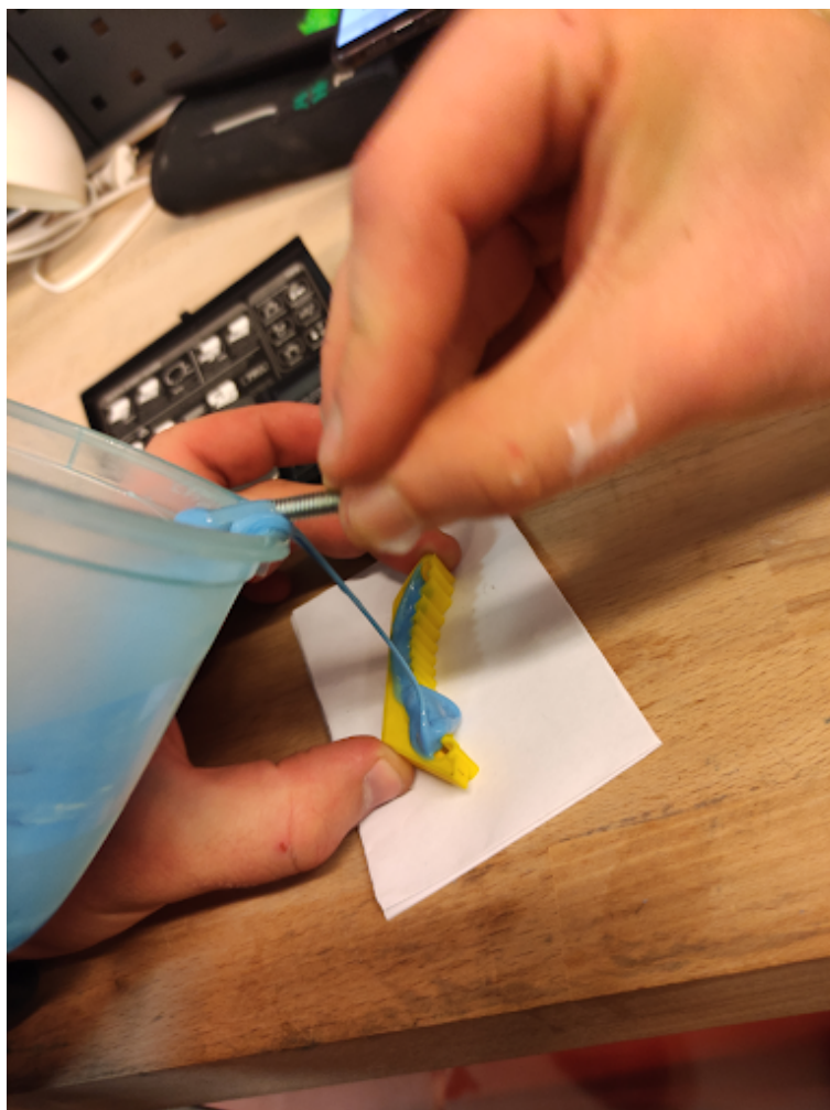
Rysunek 5.6. Proces zalewania formy silikonem
