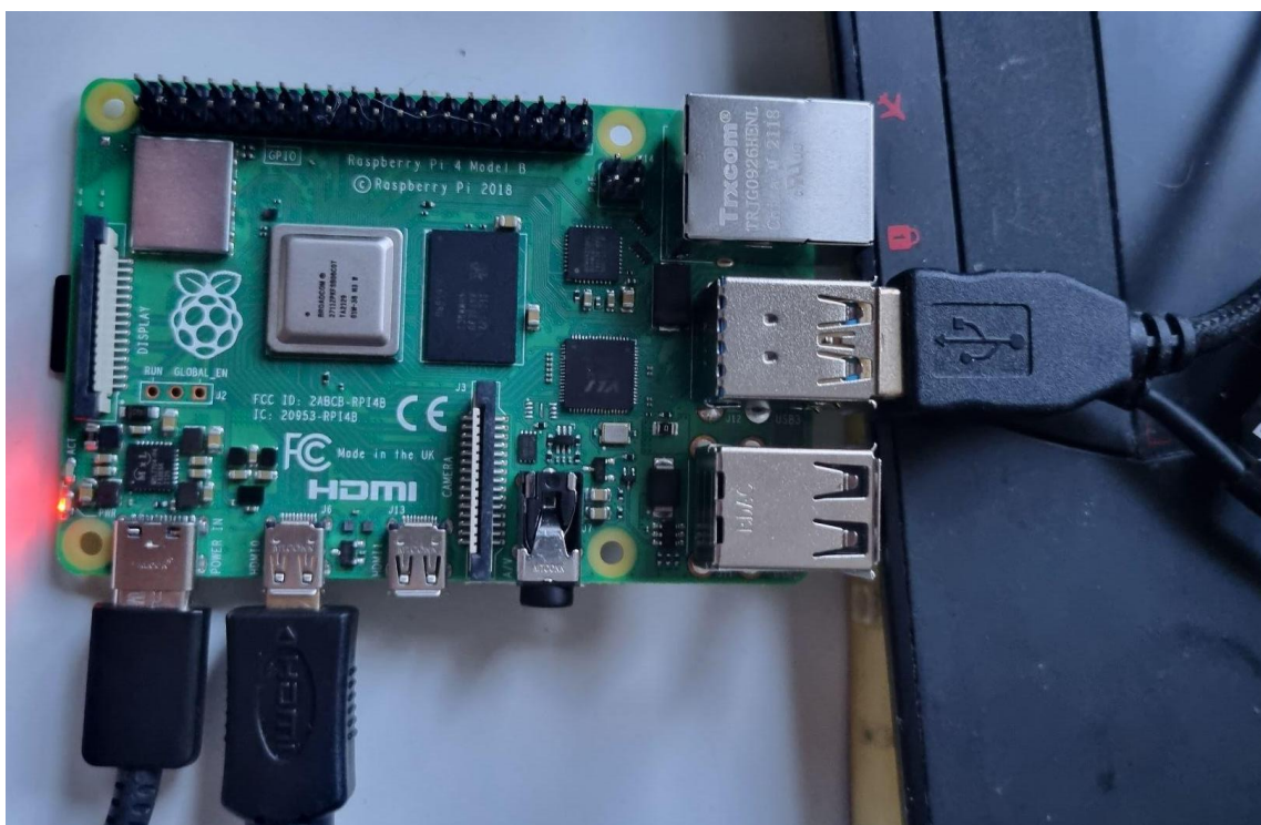
Rys. 4.3. Połączenie przewodów do Raspberry Pi
