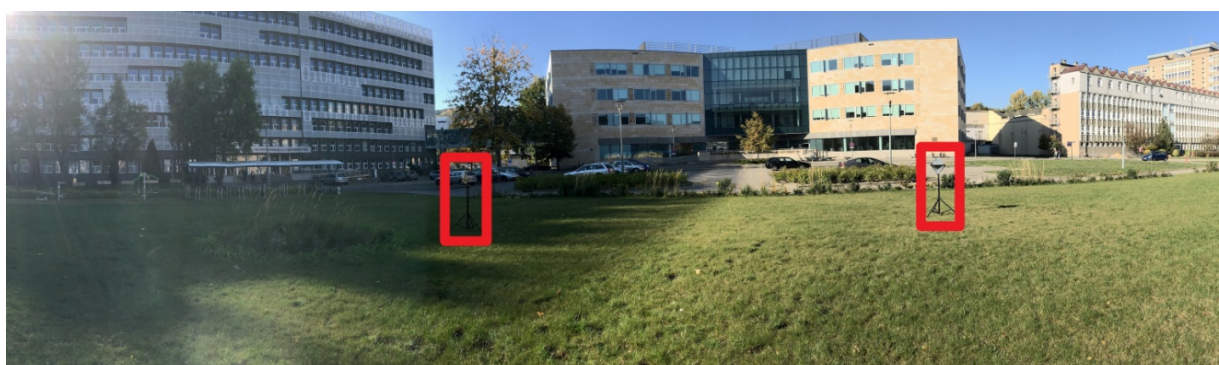
Rys. 5.5. Rozmieszczenie reflektorów (obszar odpowiadający zakresowi 160-20 stopni na planszy radaru, licząc od prawej strony zdjęcia)
