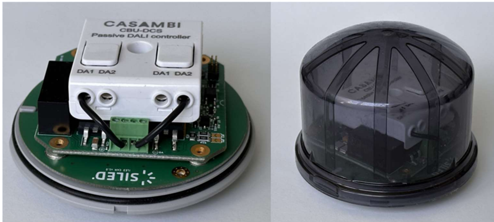
Fot. 9. Prototyp Modułu Casambi, bez obudowy i z obudową
