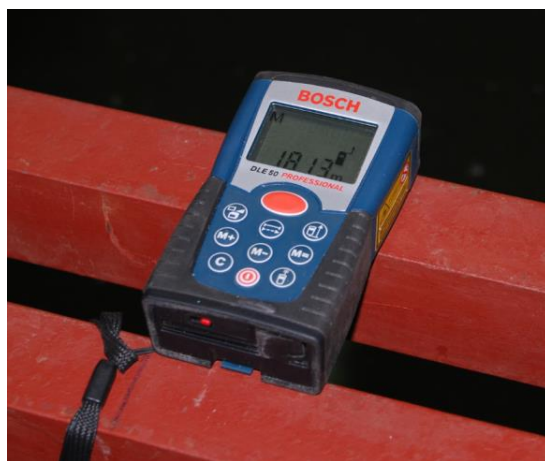
Rysunek 5-35 Stanowisko do pomiaru amplitudy oraz kształtu impulsów sondujących wraz z odległością (po lewej) laserowy miernik do określenia odległości hydrofonu od przetwornika (po prawej)
