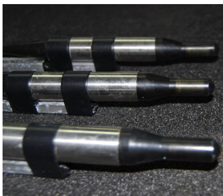
Rysunek 5-42 Hydrofony pomiarowe używane podczas rejestracji impulsów sondujących
