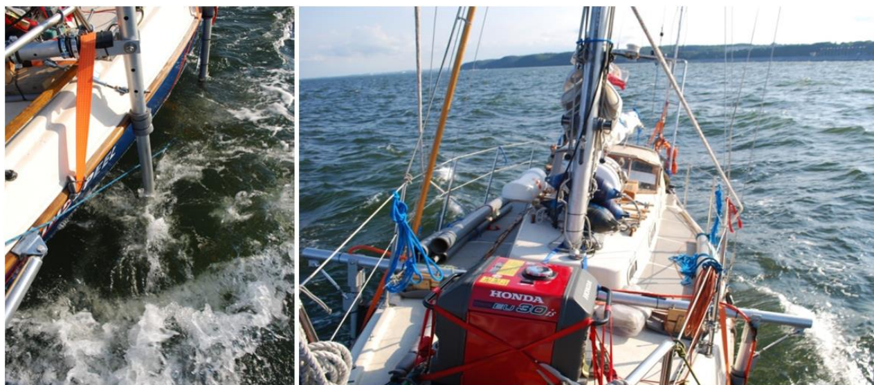
Rysunek 5-71 Uchwyt echosondy wielowięzkowej (po lewej stronie), agregat zainstalowany na dziobie jednostki pomiarowej (po prawej stronie)
