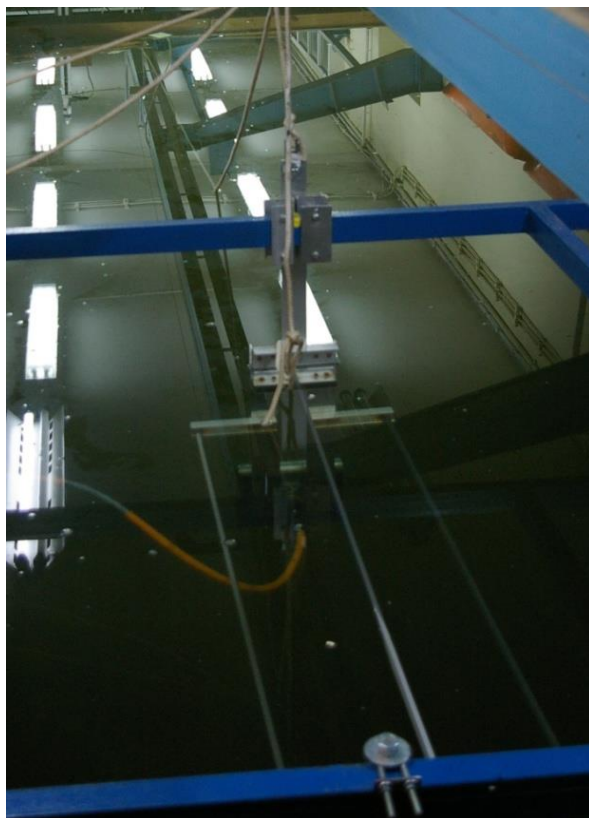
Rysunek 5-20 Antena echosondy parametrycznej na stelażu
