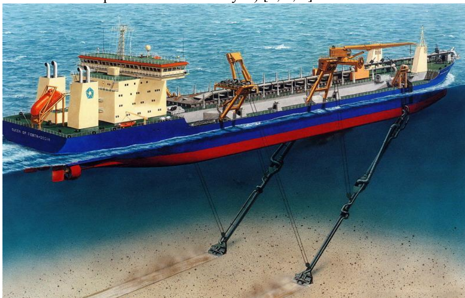
Rys. 1. Widok pogłębiarki ssącej nasiębiernej podczas załadunku
