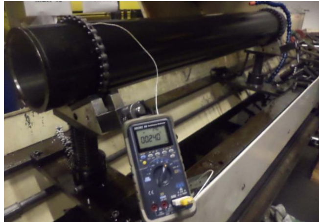
Rys. 105. Pomiar temperatury przy pomocy czujnika dotykowego (kalibracja kamery termowizyjnej)
