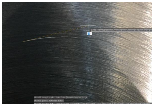
Rys. 160. Uzyskana tekstura powierzchni gładzonej dla zmiennej prędkości skoku w zakresie 1000 ÷ 3000 mm/min – średni kąt nachylenia stycznej do trajektorii ziarna 14°
