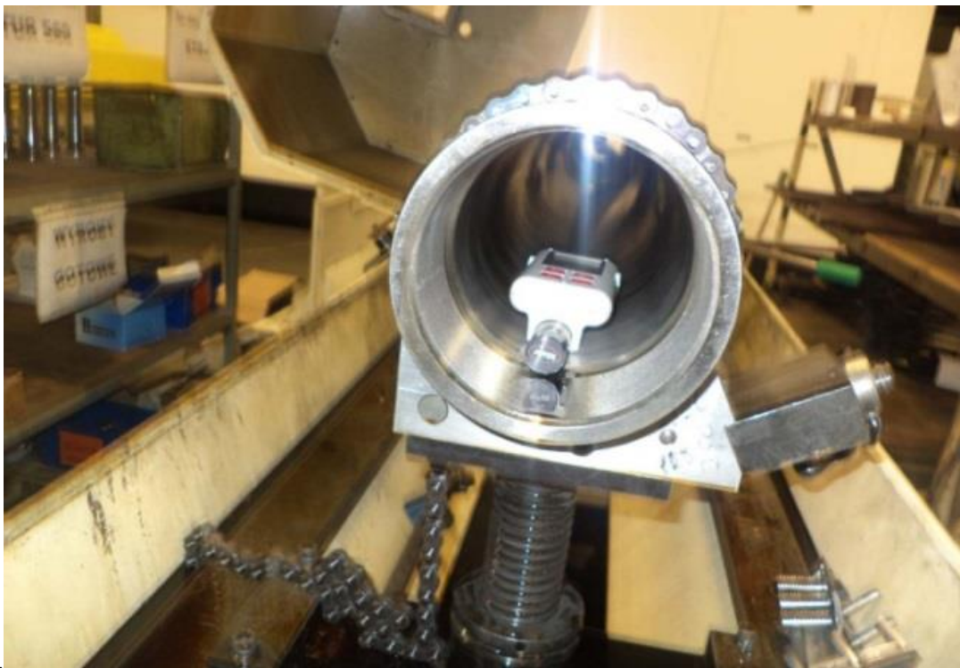
Rys. 104. Pomiar chropowości gładzonego otworu (przedmiotu z rys. 109) z użyciem profilografometru - my Mahr
