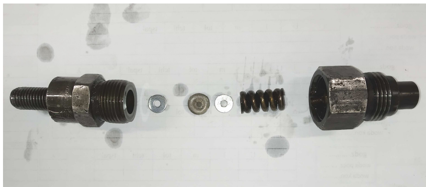
Rys. 4.22. Widok elementów konstrukcyjnych zastosowanego podczas badań wtryskiwacza wraz z wymiennymi (regulacyjnymi) podkładkami pod sprężyną wtryskiwacza
