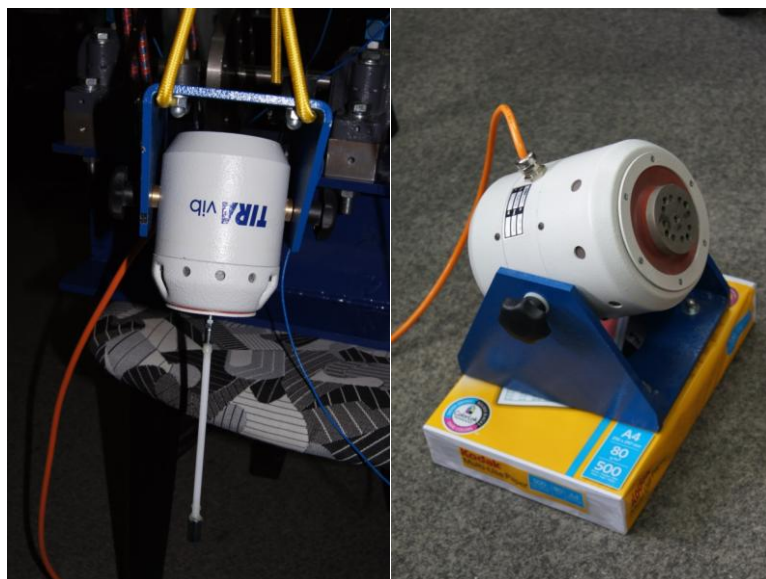
Rys. 3. Wzбудniki drgań: TIRA TV 50018 (po lewej) oraz TIRA TV S 51110 (po prawej)
