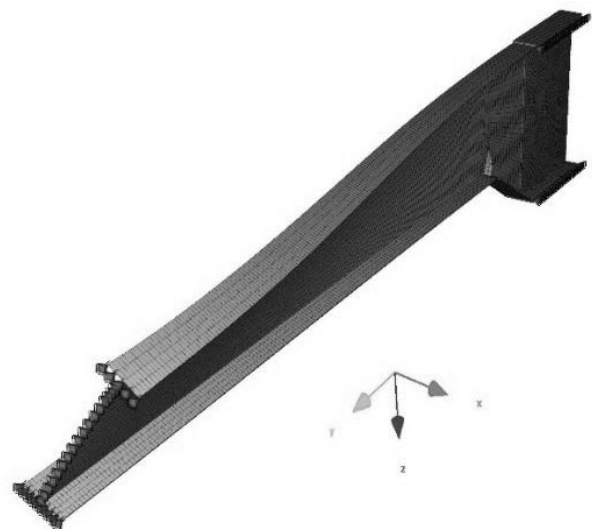
Rys. 9. Postać wyboczenia poprzecznic przy współczynniku 1,02
