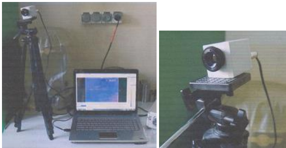
Rys.4. Widok stanowiska do pomiaru temperatury składającego się z przenośnego komputera i kamery termowizyjnej.
