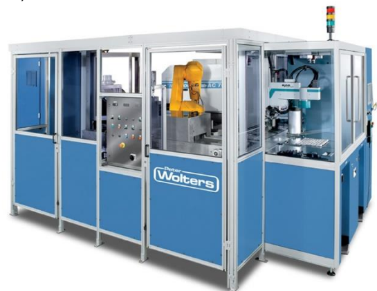
Rys. 2.11. Automatyzacja transportu elementów docieranych: a) manualne stoły załadunkowe w docierarce jednotarczowej Stähli FLM 1000 [89], b) stoły załadunkowe w docierarce dwutarczowej Stähli DLM 705 [89], c) mikro linia Lapmaster Walters AC 1000-F [88], d) wykorzystanie robota, jako podajnik w docierarce firmy Lapmaster Walters [88]
