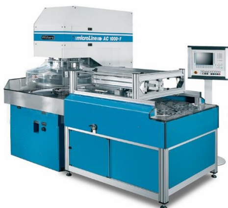
Rys. 2.11. Automatyzacja transportu elementów docieranych: a) manualne stoły załadunkowe w docierarce jednotarczowej Stähli FLM 1000 [89], b) stoły załadunkowe w docierarce dwutarczowej Stähli DLM 705 [89], c) mikro linia Lapmaster Walters AC 1000-F [88], d) wykorzystanie robota, jako podajnik w docierarce firmy Lapmaster Walters [88]
