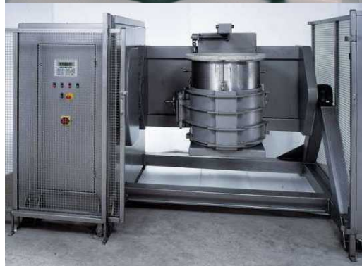
Rys. 1. Przemysłowe urządzenia do mieszania proszków: a) mieszalnik typu „turbula” (popularny w polskim przemyśle), b) mieszalnik do przygotowania dużych ilości proszków typu Dyna-Mix [17]
