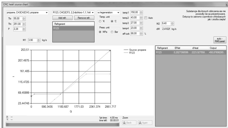
**Rys. 7.** Wartość strumienia ciepła, transportowanego przez propan i możliwy do odebrania przez czynnik roboczy układu ORC strumień ciepła wraz z obliczeniem możliwej do wygenerowania mocy elektrycznej
