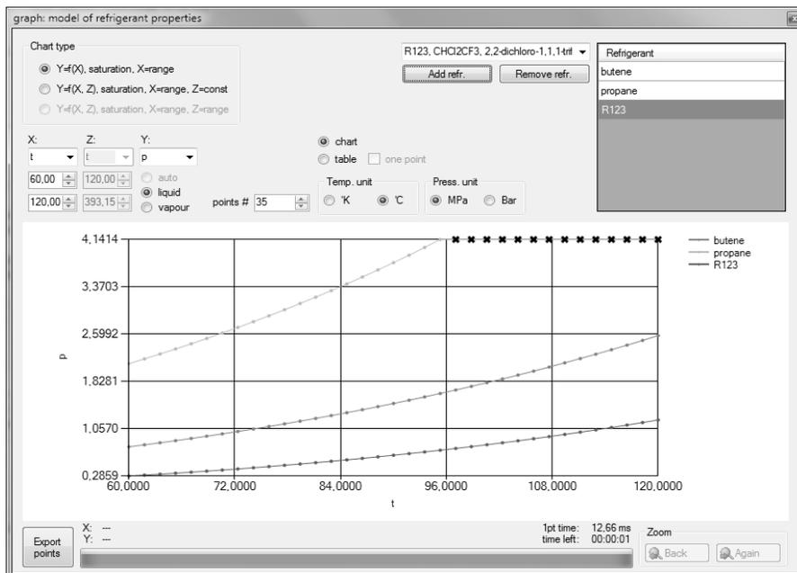
Rys. 2. Graficzne zestawienie parametrów termodynamicznych wybranych czynników
