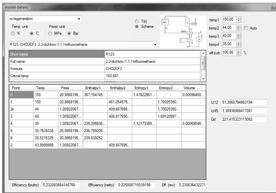
Rys. 4. Parametry termodynamiczne w punktach charakterystycznych układu
