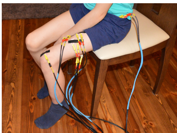
Rysunek 5.19. Rozmieszczenie elektrod podczas badania ruchu kończyny dolnej
