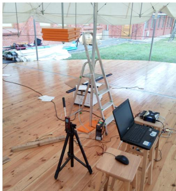
Rys. 66 Punkty przyłożenia obciążenia i rejestrowania przemieszczeń w badaniu statycznym namiotu o powierzchni 160 m 2 .
