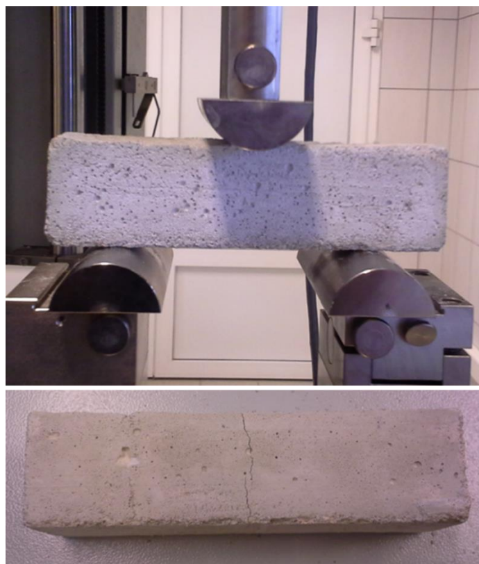
Rys. 40 Próbka zaprawy poddana zginaniu w trakcie oraz po badaniu
