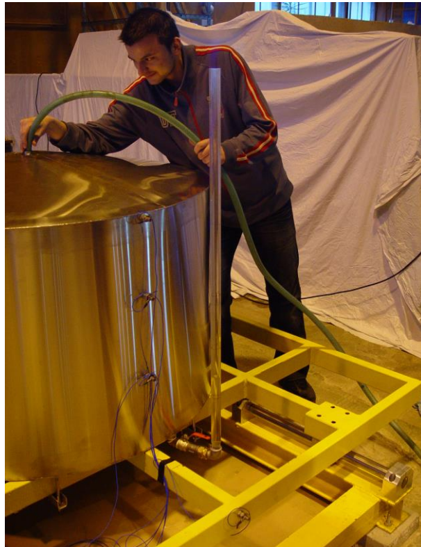
Fot. 3.4. Metoda wypełniania modeli oraz kontrolowania poziomu słupa wody
