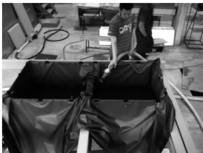
Rys. 4. Napelnianie komór wanny wodą (fot. P. Lewandowski)
