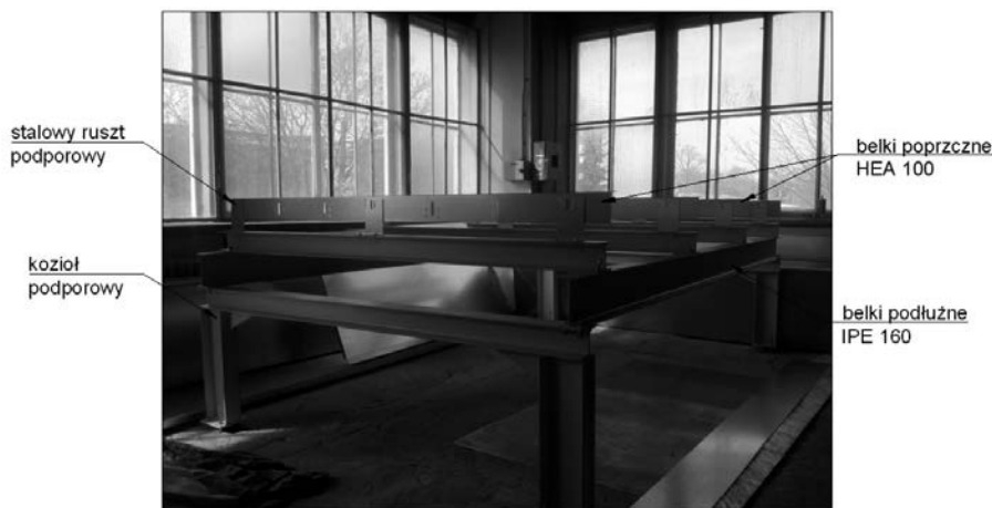
Rys. 3. Zdjęcie stanowiska badawczego z opisanimi elementami składowymi (fot. P. Lewandowski)
