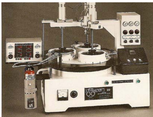
Rys.5. Docierarka jednotarczowa Lapmaster 20 [8]
