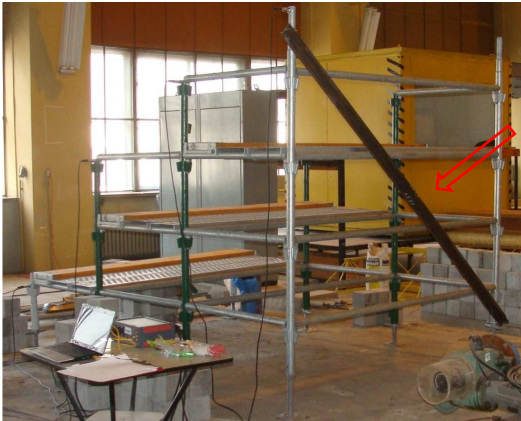
Fot. 5.6 Tymczasowa trybuna stalowa wyposażona w tłumik polimerowy (widok z tyłu).
