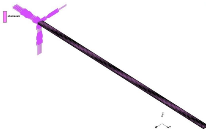
Rys. 4.249 Model numeryczny pojedynczej aluminiowej belki wspornikowej.
