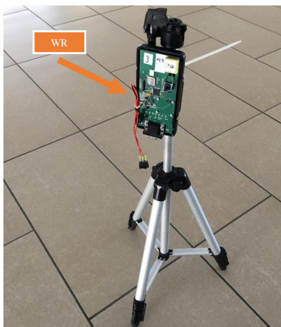
Rys. 6.3. Sposób umieszczenia węzłów referencyjnych WR na statywach.
