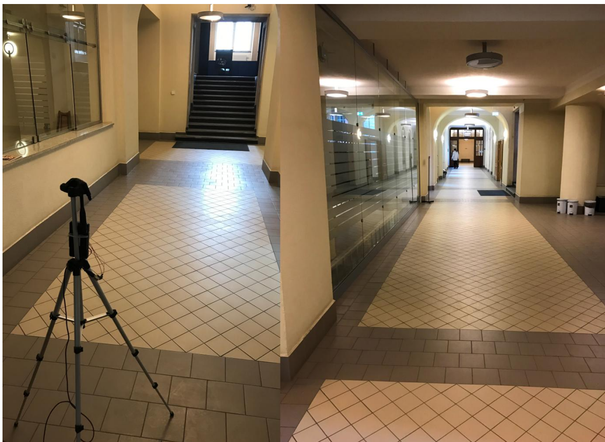
Rys. 5.6. Zdjęcie stanowiska pomiarowego w rzeczywistym wewnątrzbudynkowym środowisku propagacyjnym.
