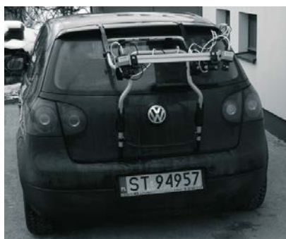
Fot. 3. Sposób montażu systemu stereowizyjnego [7]
