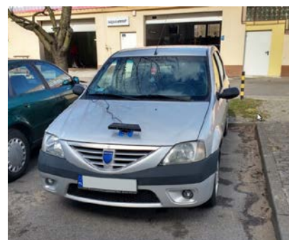
Fot. 4. Samochód z zamontowanym sensorem Kinect. Źródło: opracowanie własne
