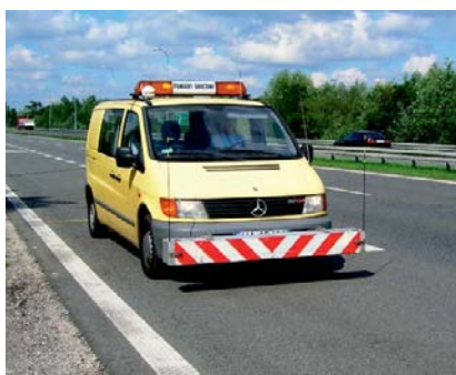
Fot. 2. Wykorzystywany przez GDDKiA profilograf laserowy [6]
