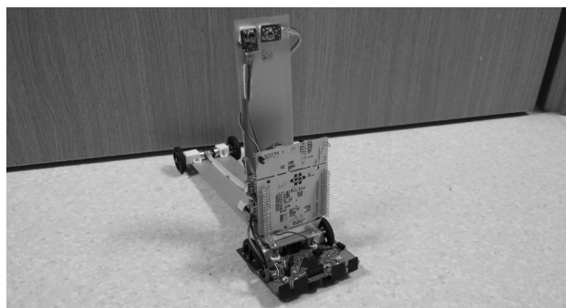
Rys. 6. Robot do automatycznego seryjnego pomiaru temperatury
