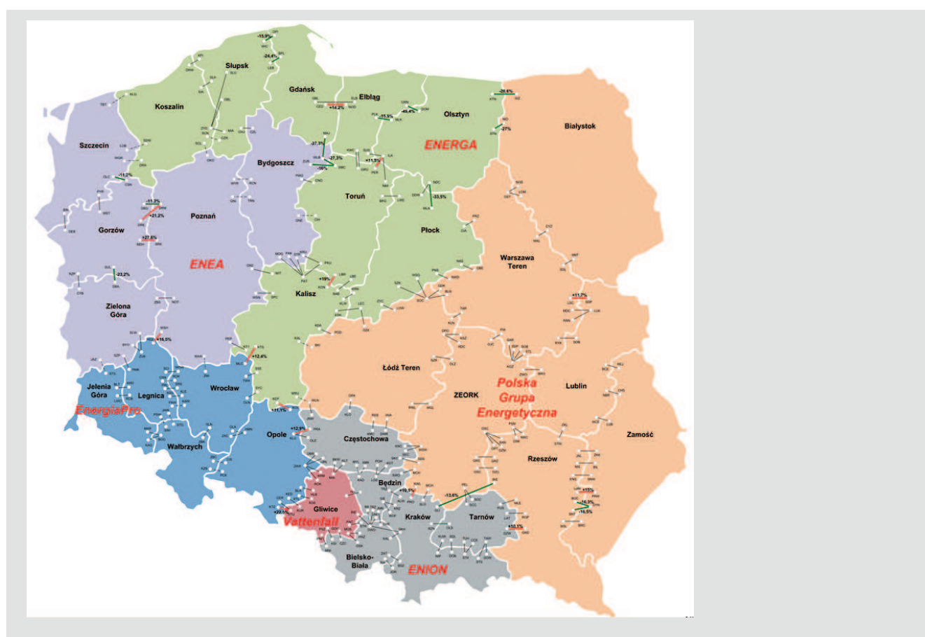
Rys. 2. Zmiana obciążenia ( \geq \pm 10\% ) w liniach łączących poszczególne ZE. Kolor czerwony – zwiększenie obciążenia, kolor zielony – zmniejszenie obciążenia. Wariant W15 50% A
