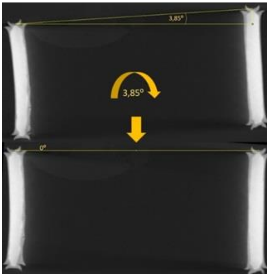
Rysunek 3.15 – Obrót skanu w celu uzyskania osiowego położenia kolejnych plastrów. Obrót pokazany na przykładzie próbki utlenianej w 1273K przez 30 min i chłodzonej w powietrzu.
