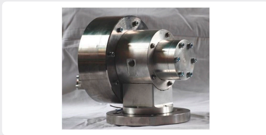
Fot. 1. Widok turbozespołu parowego
