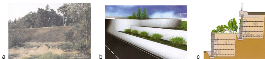
Rys. 7. Proekologiczne umocnienia skarp nasypów i ściany oporowe wzdłuż dróg dojazdowych. a) GEOWEB, b) grunt zbrojony, c) system Tensar
