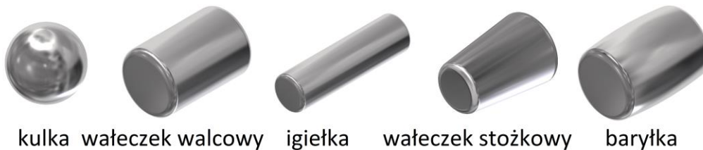
Rys. 3.3. Kształty elementów tocznych łożyska
