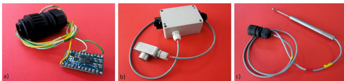
Rysunek 6.4 Stosowane czujniki pomiarowe a) prędkości kątowej- żyroskopy MEMS b) przyspieszeń – akcelerometry c) przemieszczeń – czujniki indukcyjne
