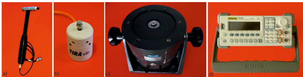
Rysunek 4.1 a) Młotek modalny PCB 086C03 b) Wzbudnik TIRA S 50009 c) Wzbudnik VEB RFT MESSELEKTRONIK d) generator RIGOL DG1022.
