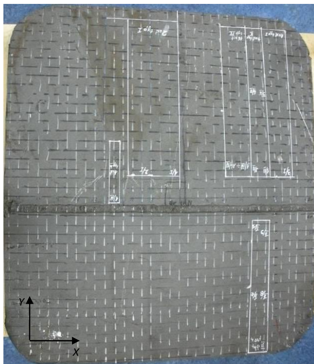
Rys 3.2. Wycinek płaszcza badanego zbiornika z zaznaczonymi miejscami pobierania próbek
