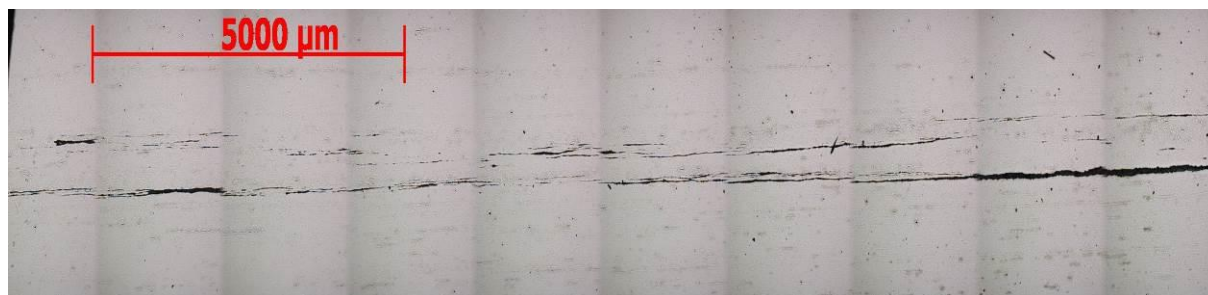
Rys. 3.6. Makrofotografia powierzchni nietrawionego zglądu (widoczne są likwacje siarczków i krzemianów), powiększenie 12×
