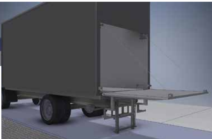
Rys. 5. Model windy pneumatycznej zamontowanej w ciężarówce Iveco Eurocargo 80E
