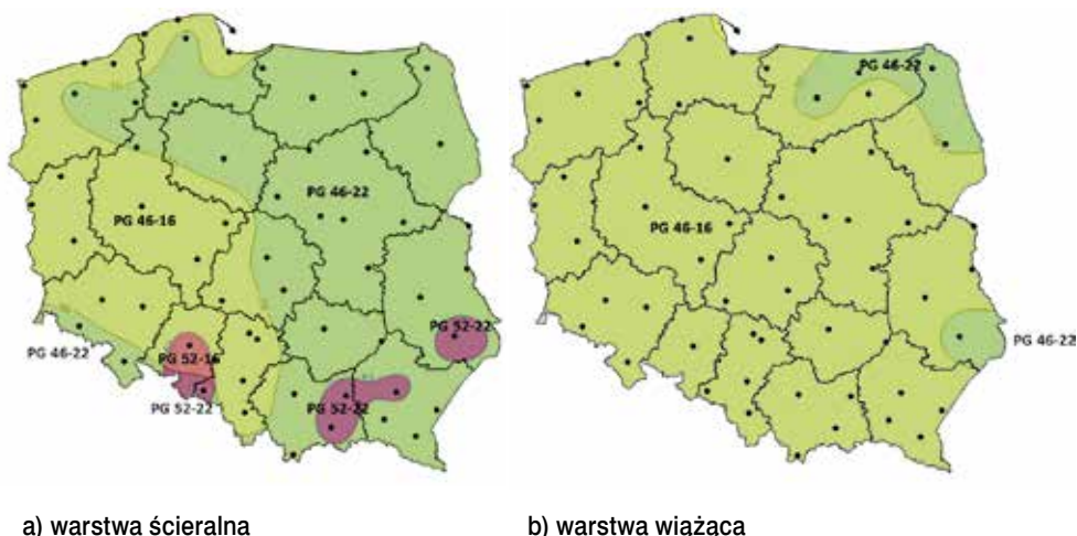
Rys. 4. Strefy klimatyczne doboru rodzaju funkcjonalnego PG asfaltów dla pozostałych dróg o kategorii ruchu KR1–KR2, poziom prawdopodobieństwa P = 50%
