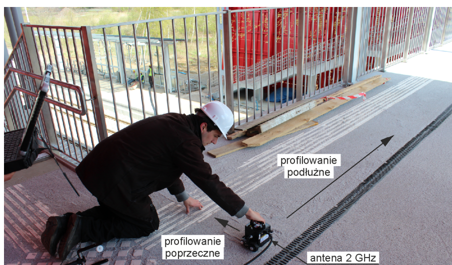
Rys. 7.21. Ramowa kładka dla pieszych podczas pomiarów w drugim terminie
