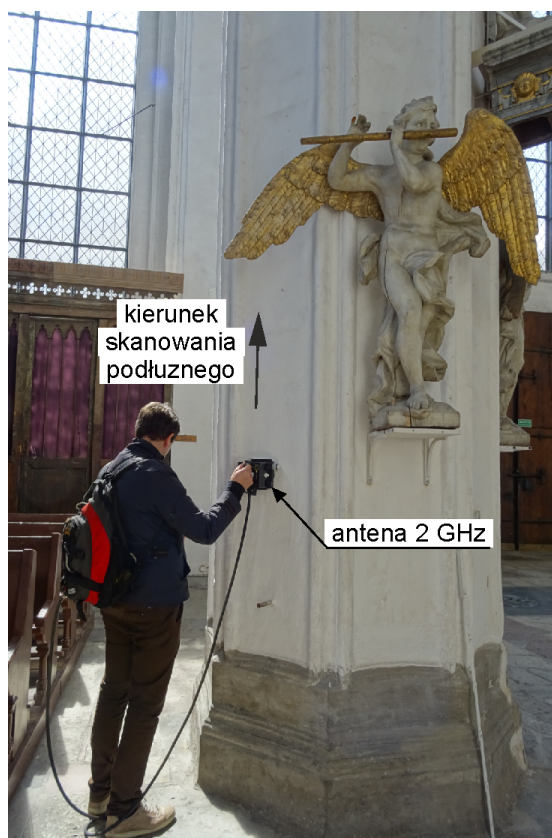
Rys. 7.47. Pomiar georadarowy wzdłuż filaru C.2
