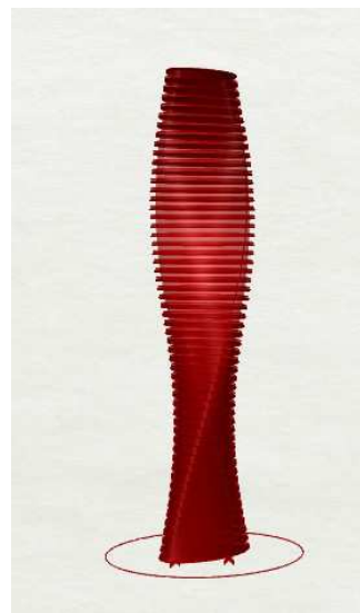
Rys.4.1.2e,f,g: Efekty działania algorytmu dla wieży na płaszczyźnie pochodnej z rodziny elipsoid, przy generowaniu skrętu za pomocą mapowania grafowego
