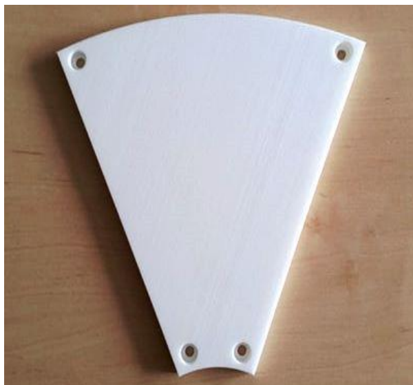
Rysunek 25. Prototypowa tarcza docierająca wykonana metodą SLS: a) widok pojedynczego segmentu ściernego; b) tarcza docierająca złożona z ośmiu segmentów ściernych
