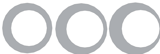
Rysunek 43 Wizualizacja przekrojów poprzecznych przestrzeni pierścieniowych o ecentryczności odpowiednio od lewej strony 25%, 50% i 75%
