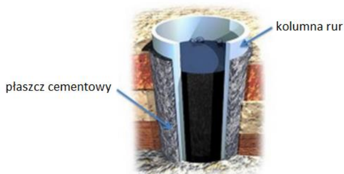
Rysunek 12 Wizualizacja płaszcza cementowego [23]
