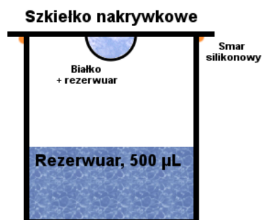
Rys. 58 Schemat krystalizacji białka metodą kropli wiszącej
