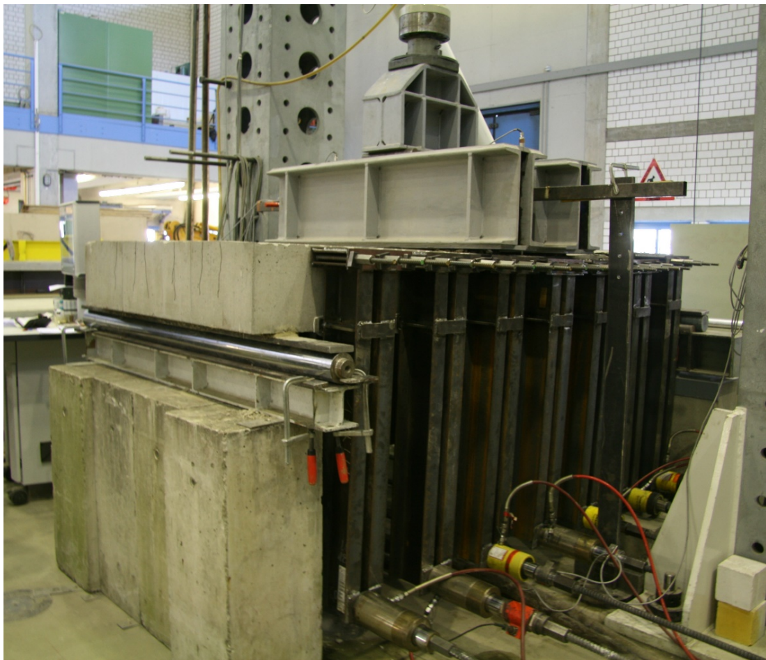
Abb. 4: Kaiserslauterer Versuche zur Querkrafttragfähigkeit im Bereich gegensinniger Momente: a) Stahlzangenkonstruktion, b) Durchführung eines Versuches
