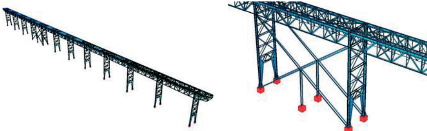
Rys. 4. Wizualizacja schematu obliczeniowego konstrukcji M1 (cała estakada)
