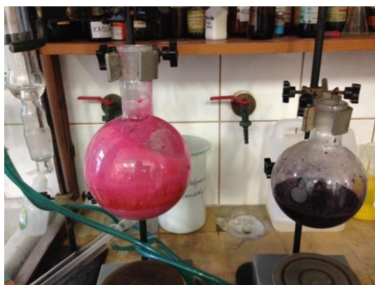
Rysunek 7. Zdjęcie laków barwnych w trakcie ich wytwarzania (po lewej stronie lak z drzewa brazylijskiego, po prawej stronie lak z koszenili).
