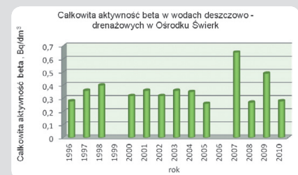
Rys. 3. Analiza całkowitej aktywności beta w wodach deszczowo-drenażowych na terenie ośrodka w Świerku, na podstawie [6]
