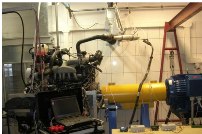
Rys. 3. Hamownia silnikowa, stanowisko do badań konwersji reaktora katalitycznego
