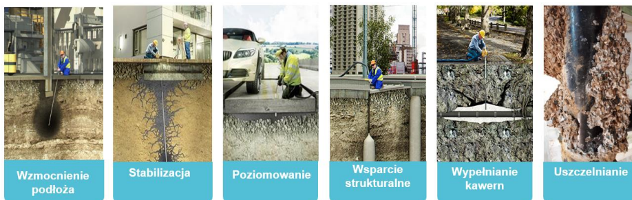
Rysunek 4. Zastosowanie iniekcji geopolimerowych (Geobear sp. z o.o.)
