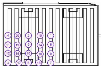
Rys. 3. Rozmieszczenie na płycie boiska 20 obserwatorów do określenia wskaźnika ośnienia GR
