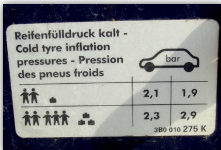
Rys. 6.4. Tabliczka informacyjna na pojeździe z zaleconym przez producenta ciśnieniem w ogumieniu
