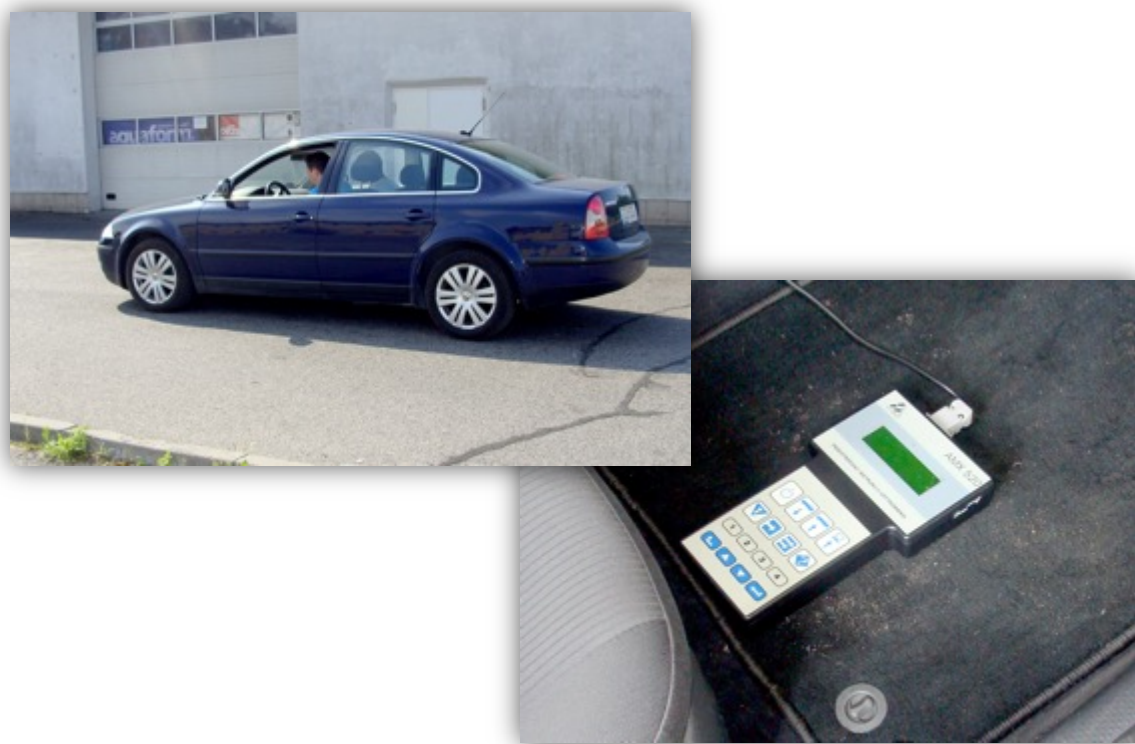
Rys. 6.9. Pomiar opóźnienia za pomocą urządzenia AMX 520 firmy Automex na drodze podczas hamowania
