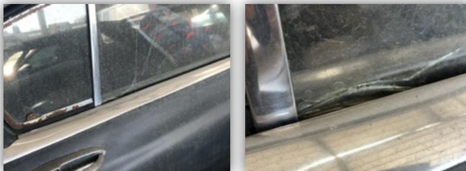
Rys. C.5. Pęknięta szyba – usterka nr 3.1 (WIDOCZNOŚĆ / Stan szyb)
