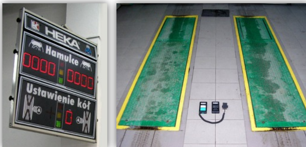
Rys. 6.7. Urządzenie płytowe firmy HEKA do badania hamulców
