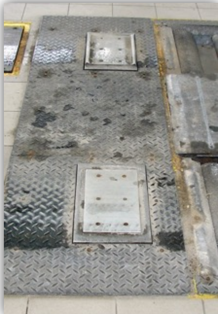
Rys. 6.11. Stanowisko do pomiaru tłumienia zawieszenia – Cartec SSP 2000: a) płyty pomiarowe, b) jednostka centralna
