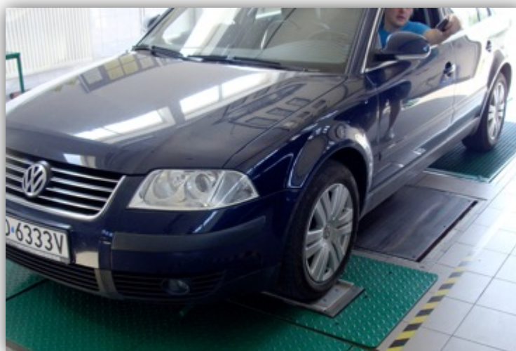
Rys. 6.12. Pomiar tłumienia zawieszenia na stanowisku płytowym Cartec SSP 2000
