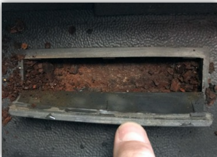
Rys. 2.17. Skorodowany numer identyfikacyjny pojazdu
