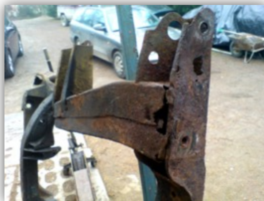
Rys. 2.16. Skorodowana rama pojazdu - Chrysler 300 z 1969 roku: a) miejsce styku z nadwoziem pojazdu, b) tylna część ramy
