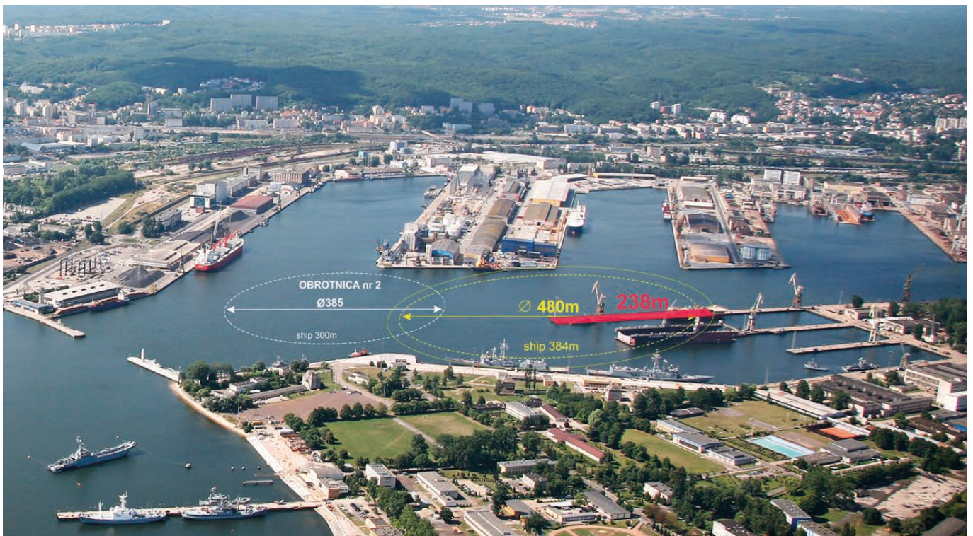
Rys. 2. Koncepcja przebudowy obrotnicy nr 2 w MPG [7]
