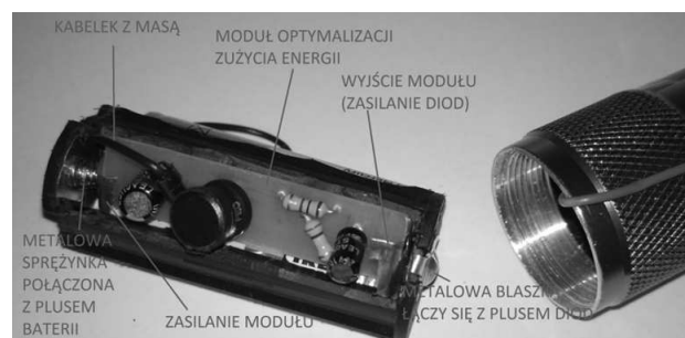
Rys. 2. Fotografia modułu zasilającego na bazie przetwornicy MCP1640
