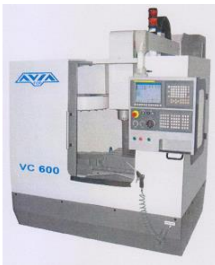
Rys. 5. Widok centrum obróbkowego VC 600; powierzchnia stołu 650x420 mm, maks. obciążenie stołu 500 kg, maks. liczba narzędzi w magazynie 20, czas wymiany narzędzia 9 sek., dokładność pozycjonowania \pm 5 \mu\text{m} , powtarzalność pozycjonowania 5 \mu\text{m} , maks. prędkość obrotowa wrzeciona 8000 \text{min}^{-1} , moc napędu głównego 11 kW [9]
